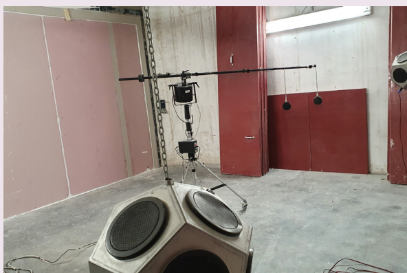
Geluidstest in een akoestisch laboratorium en waterkerende laag
